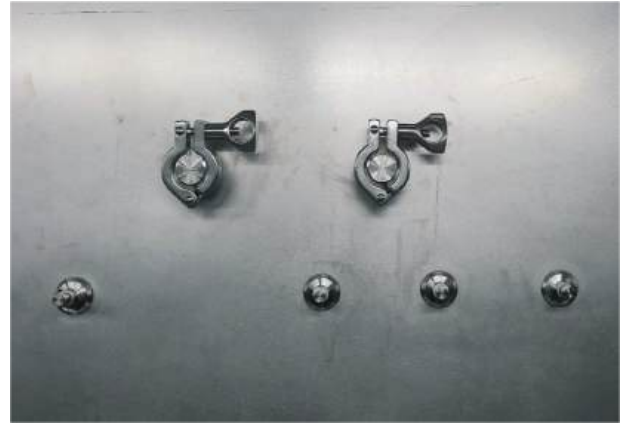
БЫСТРОРАЗЪЁМНЫЕ ЦАНГОВЫЕ ПОРТЫ для ввода инертного газа, воды, подвода вакуума, а также проходные нестерильные порты Tri-Clamp, Camlock, «One touch» и др.
