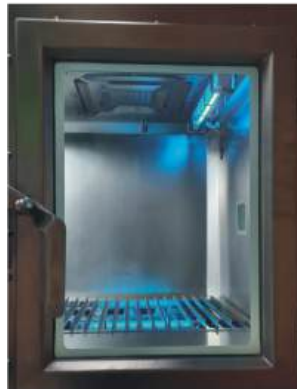
ЛАМПА УФ-ОБЛУЧЕНИЯ для дезинфекции поверхностей и материалов может устанавливаться как в рабочей камере, так и в проходном шлюзе для облучения, в том числе, донной поверхности передаваемых емкостей.
