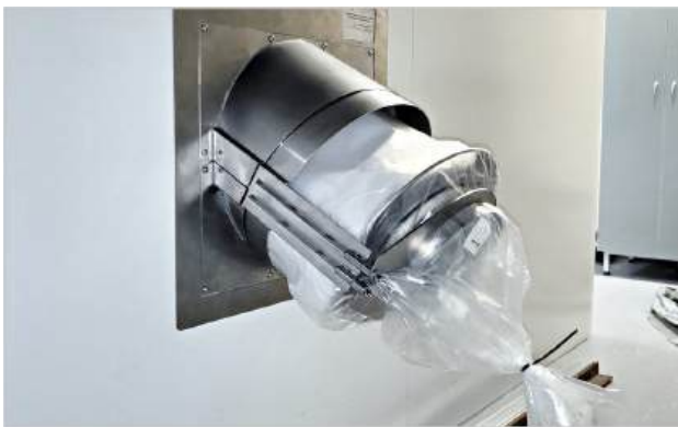
СИСТЕМА ОБЕЗЗАРАЖИВАНИЯ ПАРАМИ ПЕРЕКИСИ ВОДОРОДА. Для обработки поверхностей рабочей камеры применяется медицинский H_2O_2 концентрацией 35-37%. Для работы системы изолятор должен быть подключен к системе вытяжной вентиляции.
