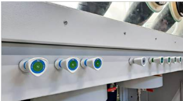
МАГИСТРАЛИ ПОДАЧИ ТЕХНОЛОГИЧЕСКИХ СРЕД с регулировочными кранами размещаются в зоне, удобной для доступа персонала.
