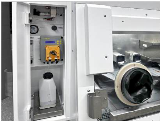
СИСТЕМА ОБЕЗЗАРАЖИВАНИЯ ПАРАМИ ПЕРЕКИСИ ВОДОРОДА. Для обработки поверхностей рабочей камеры применяется медицинский H_2O_2 концентрацией 35-37%. Для работы системы изолятор должен быть подключен к системе вытяжной вентиляции.
