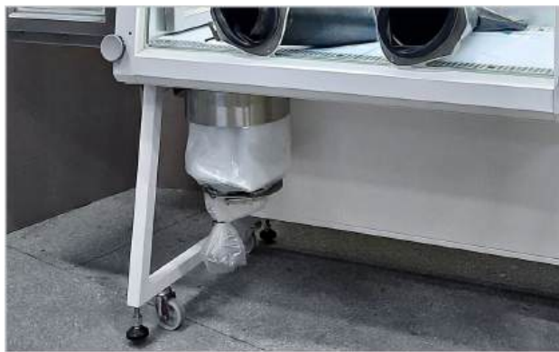
БЕСКОНЕЧНЫЙ РУКАВ ДЛЯ УДАЛЕНИЯ ТВЕРДЫХ ОТХОДОВ. Нестерильный ПВХ рукав с системой сброса предназначен для упаковки опасных веществ с последующим отделением от системы держателя и транспортировки до места утилизации. Держатель – из нержавеющей стали марки AISI 316L. Со стороны загрузки в систему сброса проем герметично закрывается люком. Замена кассеты ПВХ рукава осуществляется безопасно без разгерметизации изделия по специально разработанному алгоритму.
