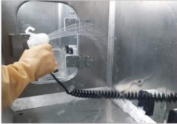
WIP(Wash-in-Place) – СИСТЕМА РУЧНОЙ МОЙКИ для дезинфекции рабочей зоны, материалов и предметов. Возможна подготовка к подключению SIP (Steril-in-Place).
