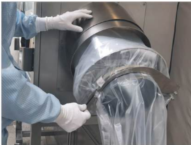
БЕСКОНЕЧНЫЙ РУКАВ ДЛЯ УДАЛЕНИЯ ТВЕРДЫХ ОТХОДОВ. Нестерильный ПВХ рукав с системой сброса предназначен для упаковки опасных веществ с последующим отделением от системы держателя и транспортировки до места утилизации. Держатель – из нержавеющей стали марки AISI 316L. Со стороны загрузки в систему сброса проем герметично закрывается люком. Замена кассеты ПВХ рукава осуществляется безопасно без разгерметизации изделия по специально разработанному алгоритму.
